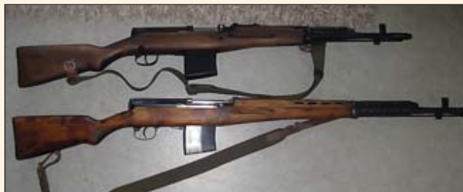
Карабин, накнадно прерађен (горе) и стандардна СВТ-40 (доле)
